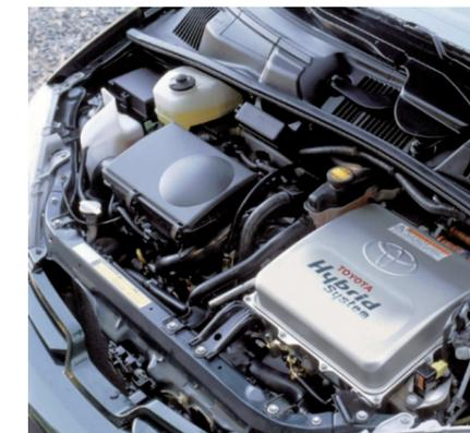
Auto ibrida: Toyota Hybrid System abina un motore a combustione interna ad un motore elettrico.
