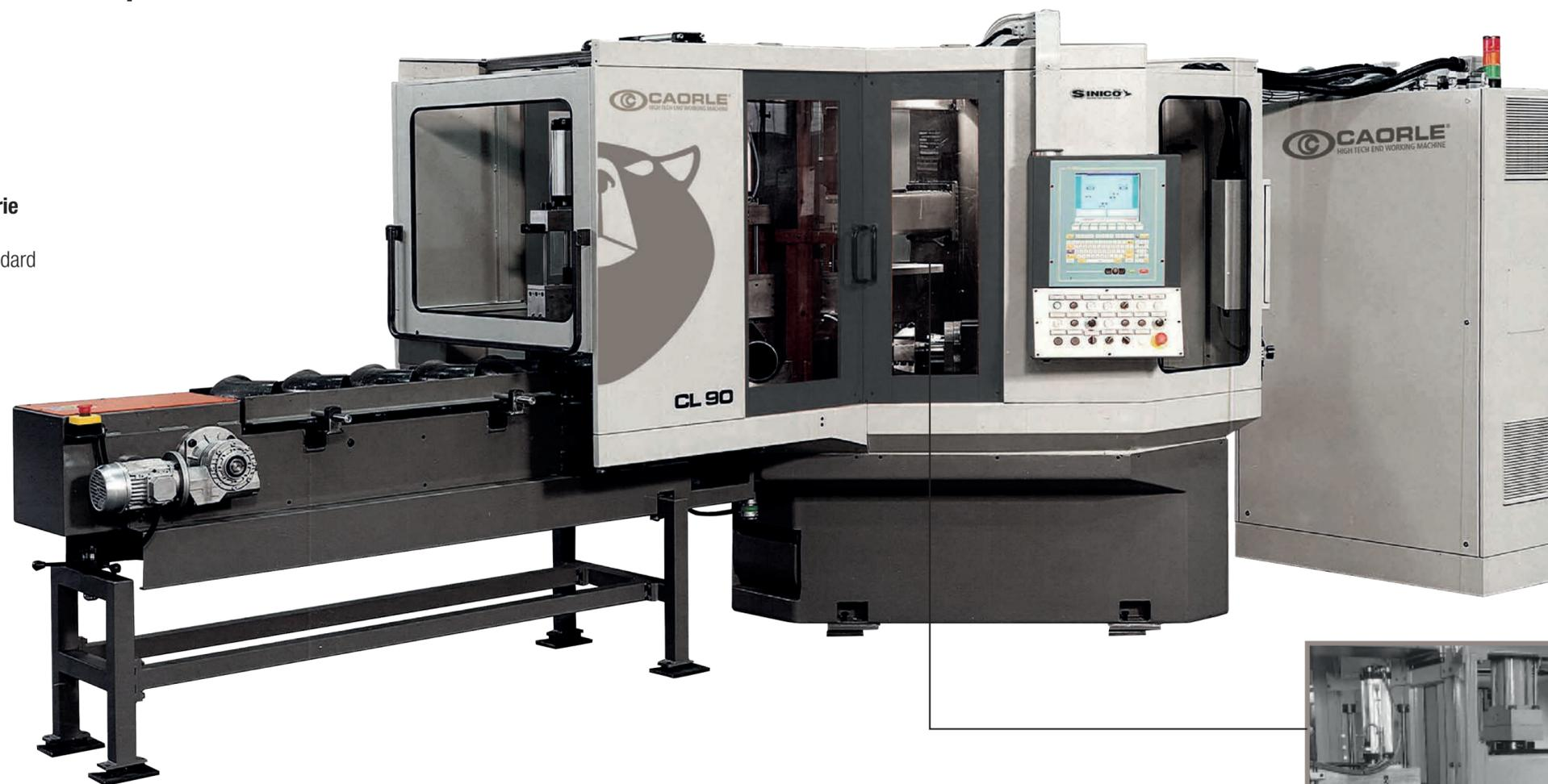
Centro di lavoro a CNC con unità a 90° per lavorazioni di raccorderia curva dotato di sistema automatico per carico/scarico del pezzo.
